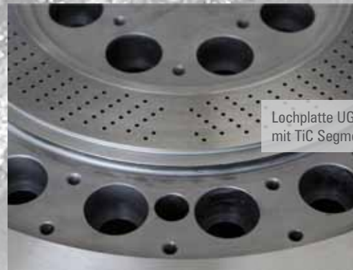
Lochplatte nach dem Neuplattieren mit TiC Segmenten
