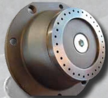
Lochplatte nach dem Neuplattieren mit TiC Segmenten
