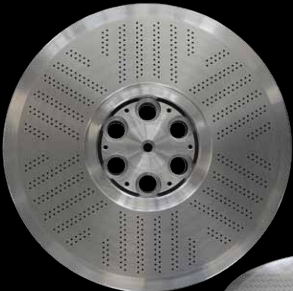
Dampfbeheizte Lochplatte, Heat Channel Design für LDPE mit 696 Loch
